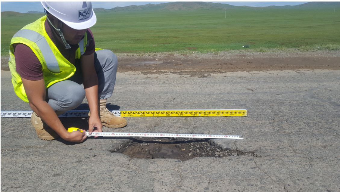
Зураг-7. Км376+320 Асфальтобетоны нүхний эвдрэлийн хэмжээг гаргаж байгаа нь
